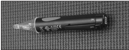
Figura 2 - Use un probador de circuitos sin contacto para asegurarse de que el suministro eléctrico está desconectado antes de trabajar en un circuito.
