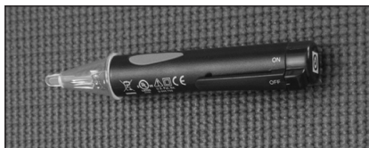
Figura 32 - Use un probador de circuitos sin contacto para verificar haya suministro eléctrico.
