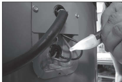
Figura 43 - Probador de circuitos sin contacto.
